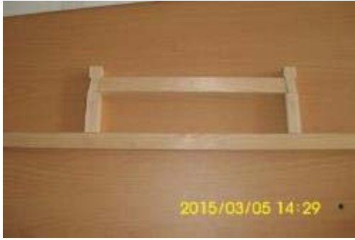
Şekil 2.37: Orta gergi Kirişinin Yerleştirilmesi
