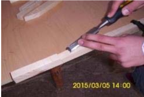
Şekil 2.12: Makas Elemanlarının Kesilmesi ve Oyulması
