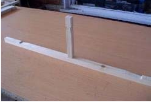
Şekil 2.15: Makas Orta Dikmesinin Yerleştirilmesi
