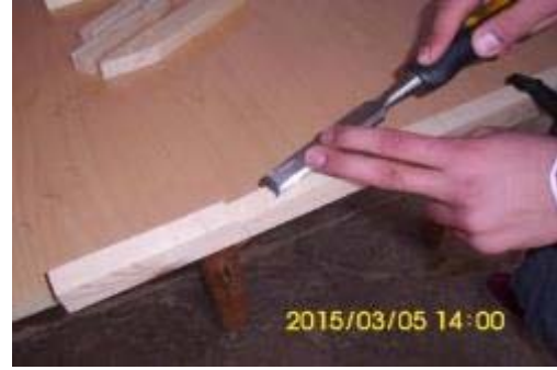
Şekil 3.5: Makas Elemanlarının Kesilmesi ve Oyulması
