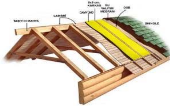
Şekil 4.3: Şingil Kaplama Katmanları
