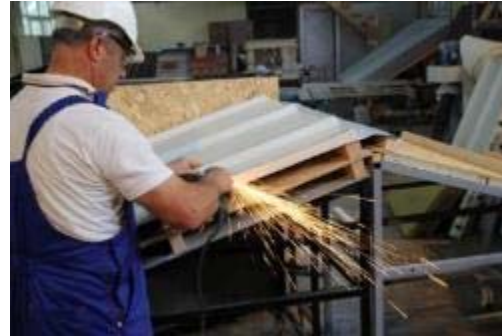
Resim 5.17: Sac Yüzeylerin Açıkta Kalan Kısımlarının Taşlanması
