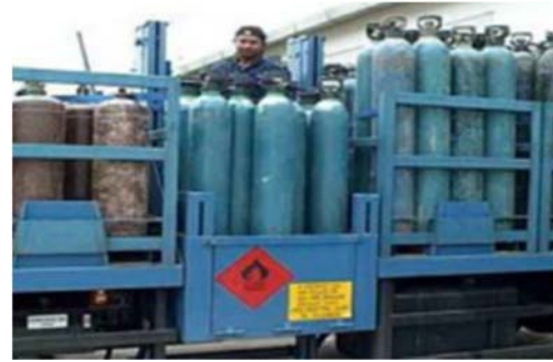
Resim 4.4: Basınçlı Tüplerin Kontrollü Şekilde Taşınması Örneđi
