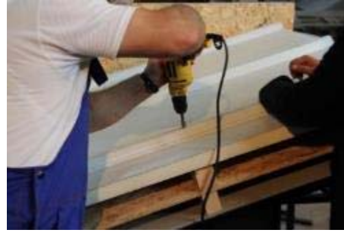
Resim 5.16: Isı Yalıtımlı Panelin Vidalanması
