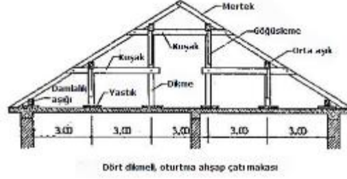
Şekil 1.2: Ahşap Oturtma Çatı
