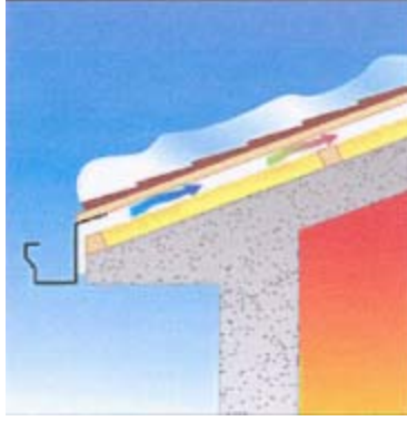
Şekil 1.5a, b: Kış Aylarında (a) Havalandırmalı Çatıda Çatı Kaplaması Üzerinde Biriken Karın Doğal Ve Eşit Bir Şekilde Erimesi Durumu ve (b) Havalandırmasız Çatıda Buzlanma Durumu
