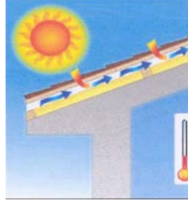
Şekil 1.4a, b: Yaz Aylarında Güneşin IR Işımlarının (a) Havalandırmasız ve (b) Havalandırmalı Çatıda Etkileri
