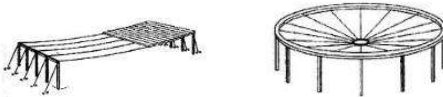
Ŗekil 1.12: Dikdrtgen ve Yuvarlak Planlı Kablolu Sistemler
